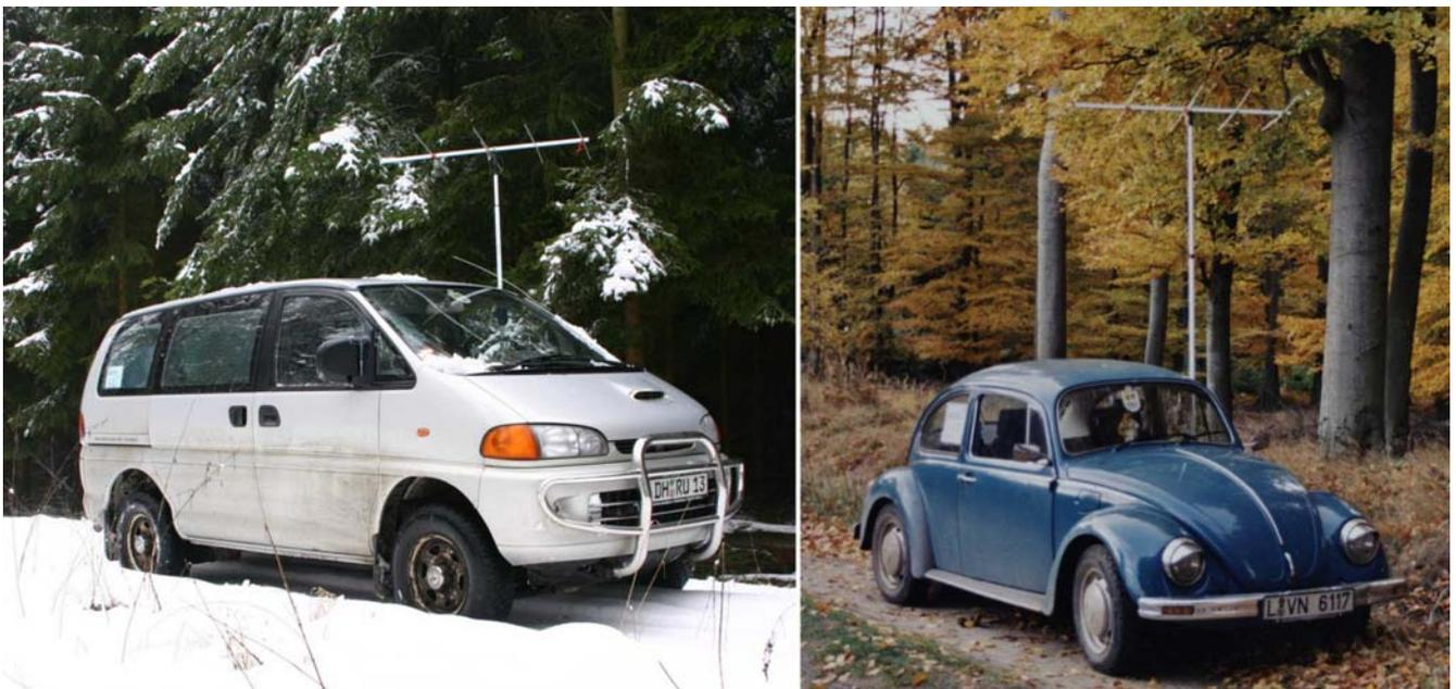
Abbildung 2-7: An KFZ montierte Telemetrieanlagen (Fotos: Oliver Keulina, Josepha Frenzel)
