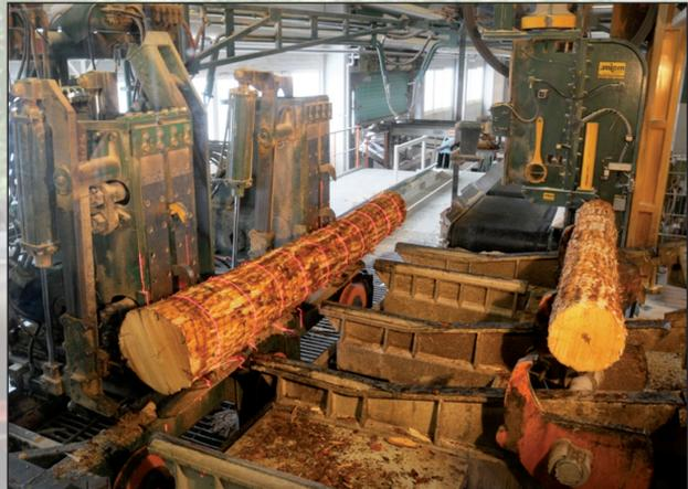
*Vermessung entrindeter Erlenstämme im Sägewerk*
